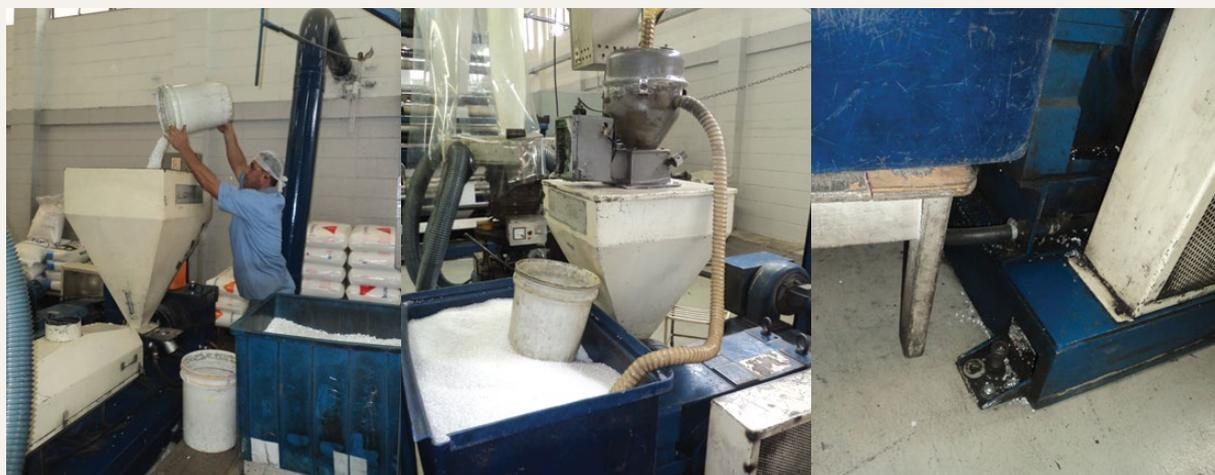
Figura 9. Exemplo de alimentação de maquinário feita de forma manual ou automática e pellets caídos junto à extrusora.
