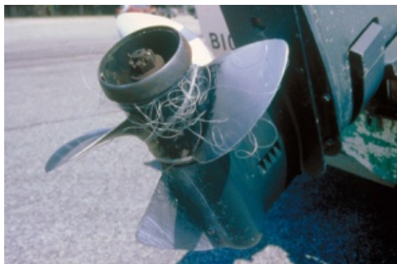
Figura 4.3. Emaranhamento de linha de pesca em hélice de motor de popa (Foto: NOAA)
